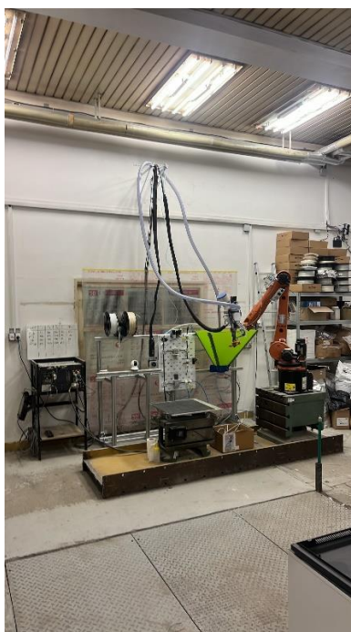
Obrázek 5 - Zleva: Silo na peletky, Uchycení hadic a kabeláže, hlavní rám konstrukce
