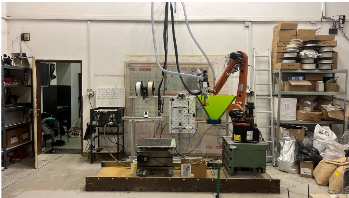
Obrázek 3 - Robotické pracoviště s konstrukcí pro polohování obslužných periférií
